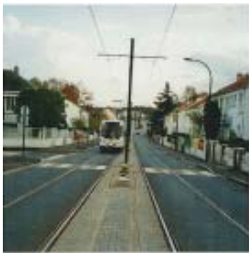
図 - 6 車道併設型 車道とは分離されておらず(段差 6 cm)軌道内の車両の通行が可能。ただし、トラムの通行が優先される。
