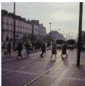
図 - 8 歩道共存型 歩行者交通を阻害する段差をなくしトラムと共存。部分的トランジットモール
